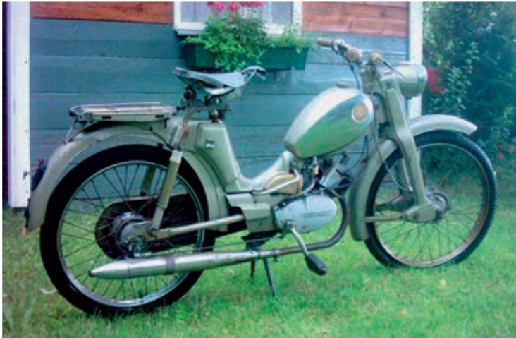
Die Zündapp Bergsteiger stand bereits werksseitig gut im Futter und verfügte über ein manuelles Schaltgetriebe mit zwei Gängen.
