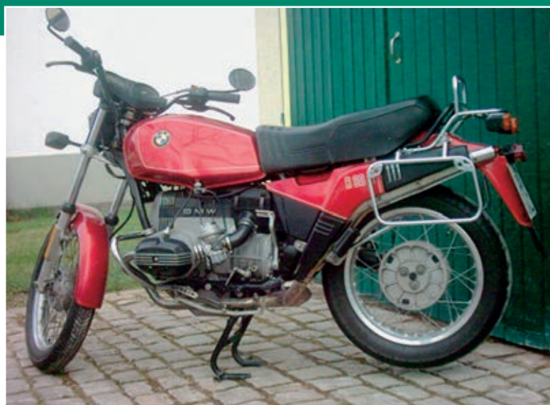
„Moderne Zeiten“: Hier kommt bereits die Einarmschwinge zum Einsatz.
